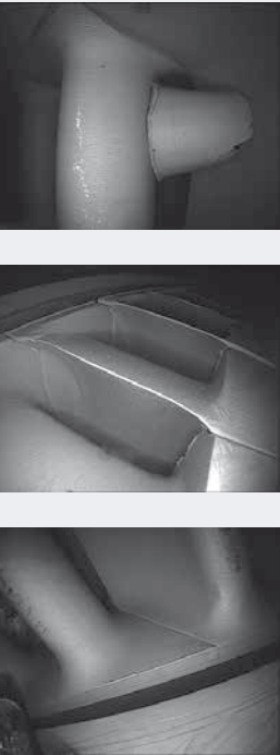
[oben] Aufnahmen der Beschäufelung im Rahmen einer Endoskopie
